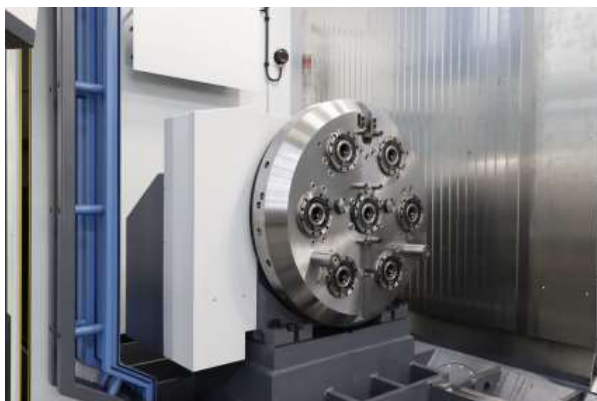
Rundtisch RTA 5 als Gegenlager mit 7 Nullpunktspannern in verstärkter Ausführung
