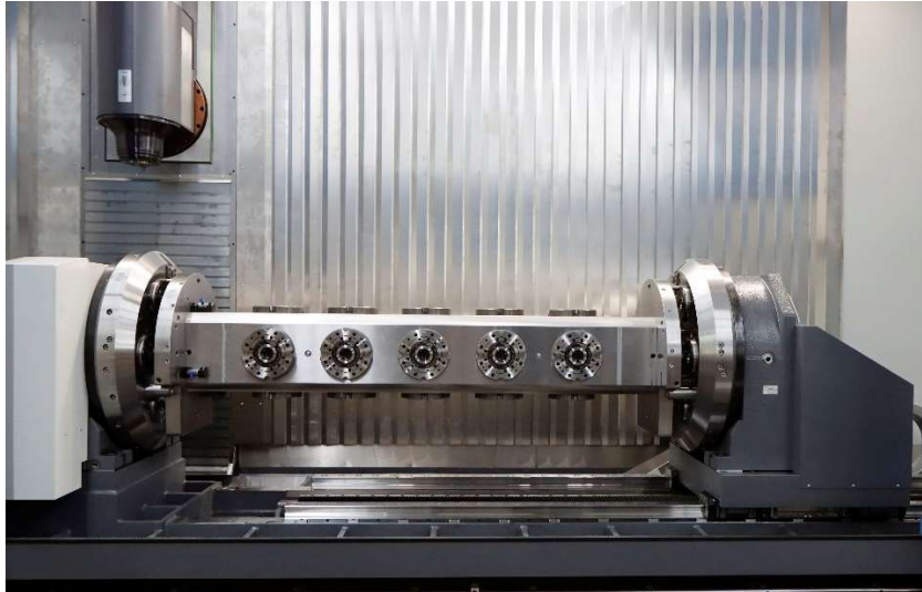
Aufgenommen von zwei Rundtischen Rechts: RTA 5 verfahrbar Links: RTA 5 als Gegenlager
