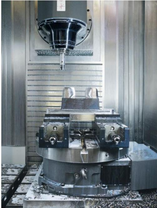
Bild 1: Bearbeitung einer Zahnleiste auf der AXA VCC 50
